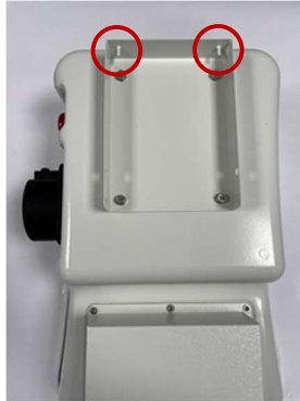
Abb. 5-2 Installation der Montageplatte an die Rückseite der Wallbox
